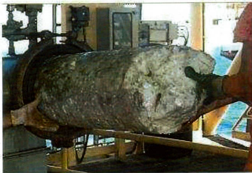
Figura 6: Formação de hidrato em tubulação da plataforma P-34, localizada na Bacia de Santos (MARIZ, 2010)
